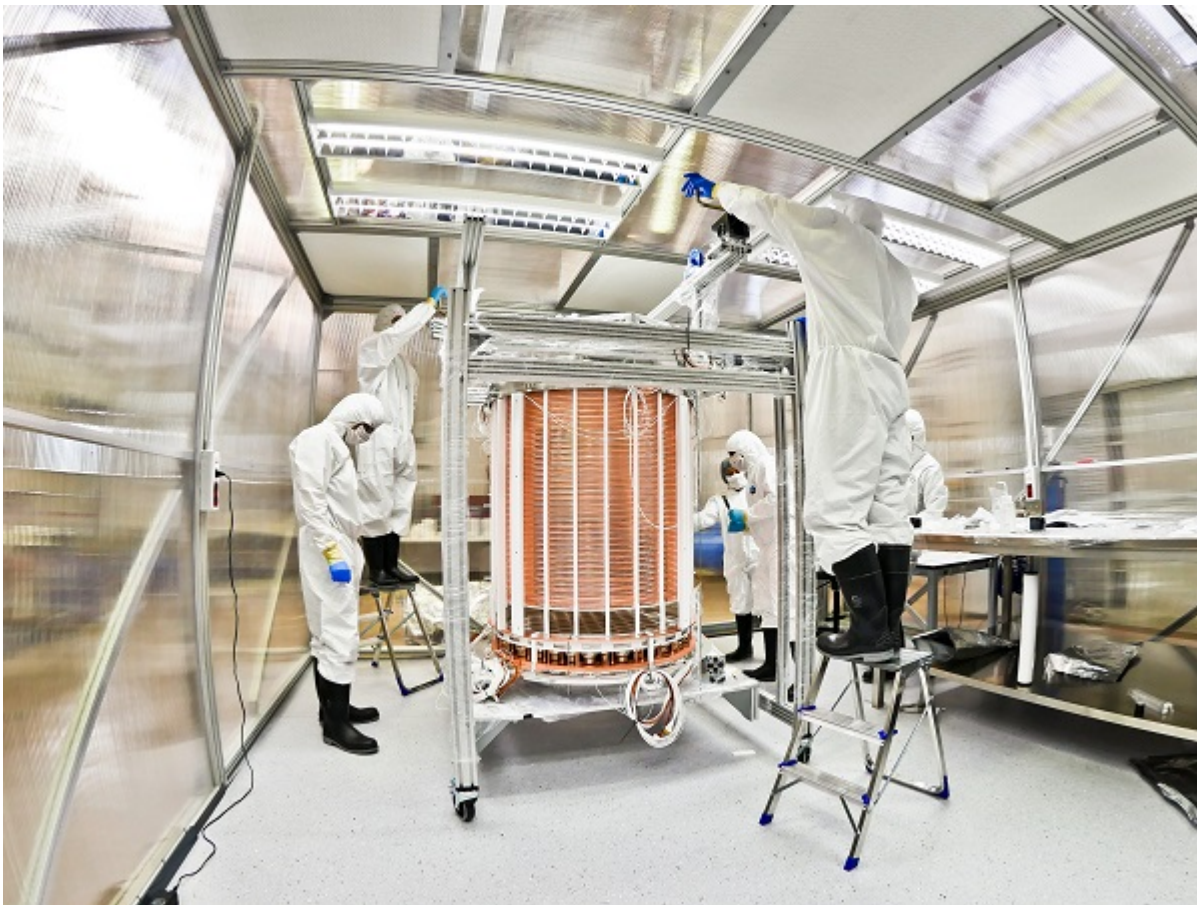
Afbeelding 1. Donkere materie waarnemen. Wetenschappers werken aan de XENON-detector. Foto: Enrico Sacchetti.
