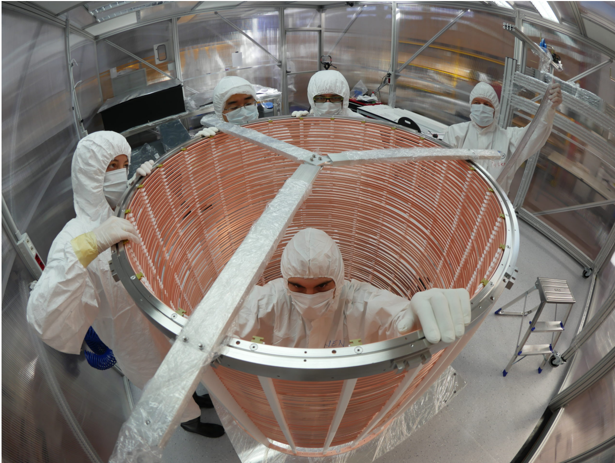
Afbeelding 3. De bouw van Xenon1T. Om ruis te voorkomen wordt de detector in een clean room in elkaar gezet. Afbeelding: XENON1T .
