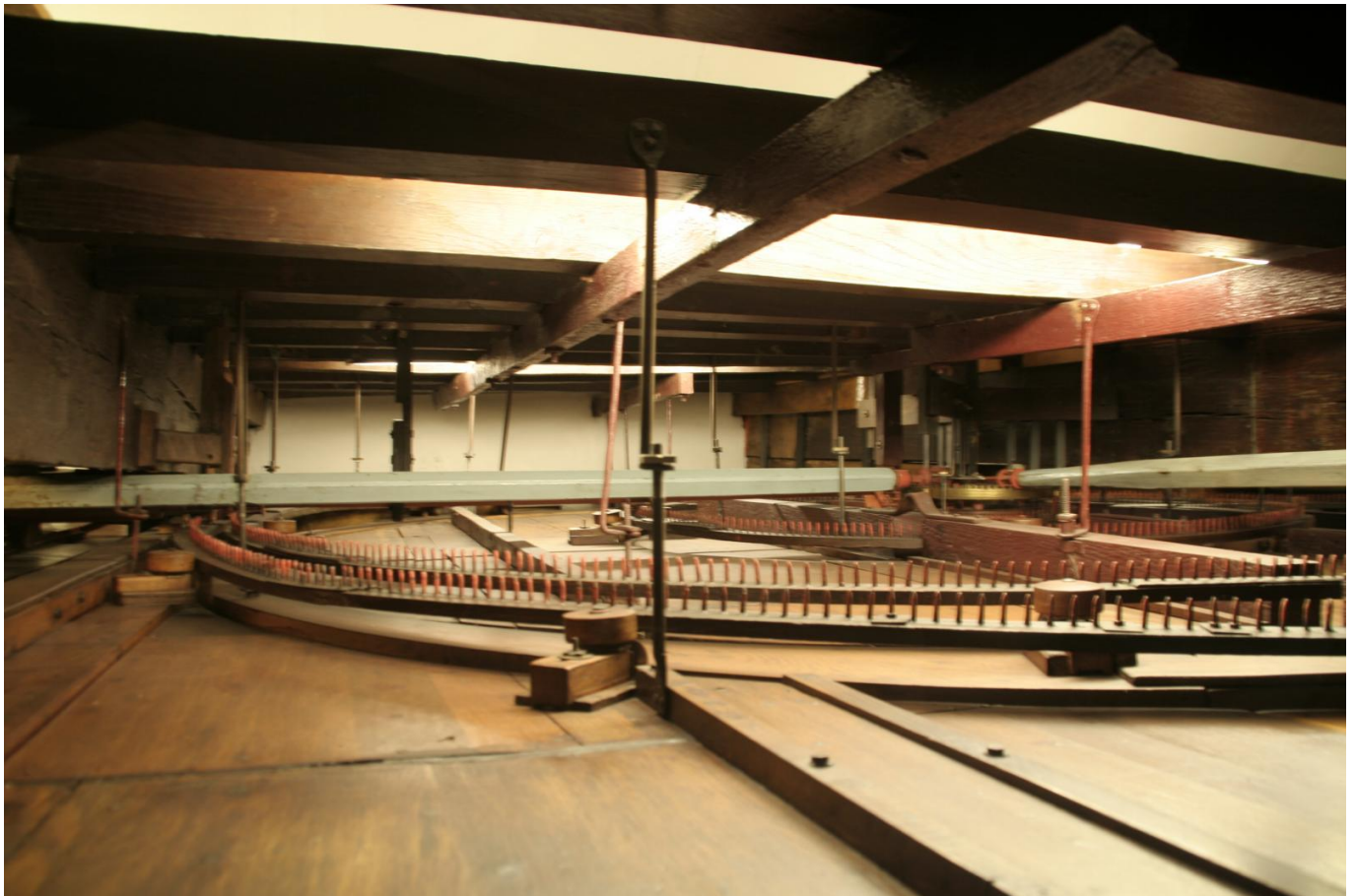
Afbeelding 3. Het mechanisme. Een klein deel van het volledig met de hand gemaakte mechanisme in het plafond van het planetarium. (Bron: Vera de Kok, Wikimedia.)
