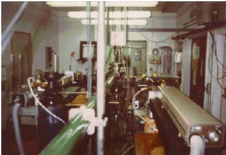
Afbeelding 5. De opstelling van Aspect. Met deze opstelling toonde Alain Aspect in 1982 aan dat informatie tussen verstrengelde deeltjes niet met een snelheid kleiner dan de lichtsnelheid uitgewisseld kon worden. Foto: Groupe d'optique atomique / LCFIO.
