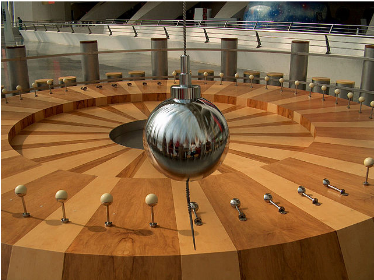
Afbeelding 1. Een slinger van Foucault. Uit een fysisch eenvoudig systeem zoals een slinger volgt uiteindelijk
