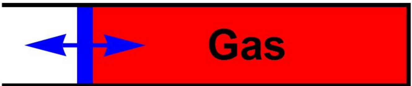
Afbeelding 1. Een zuiger Een cilinder gevuld met gas, afgesloten door een beweegbare zuiger (blauw).
