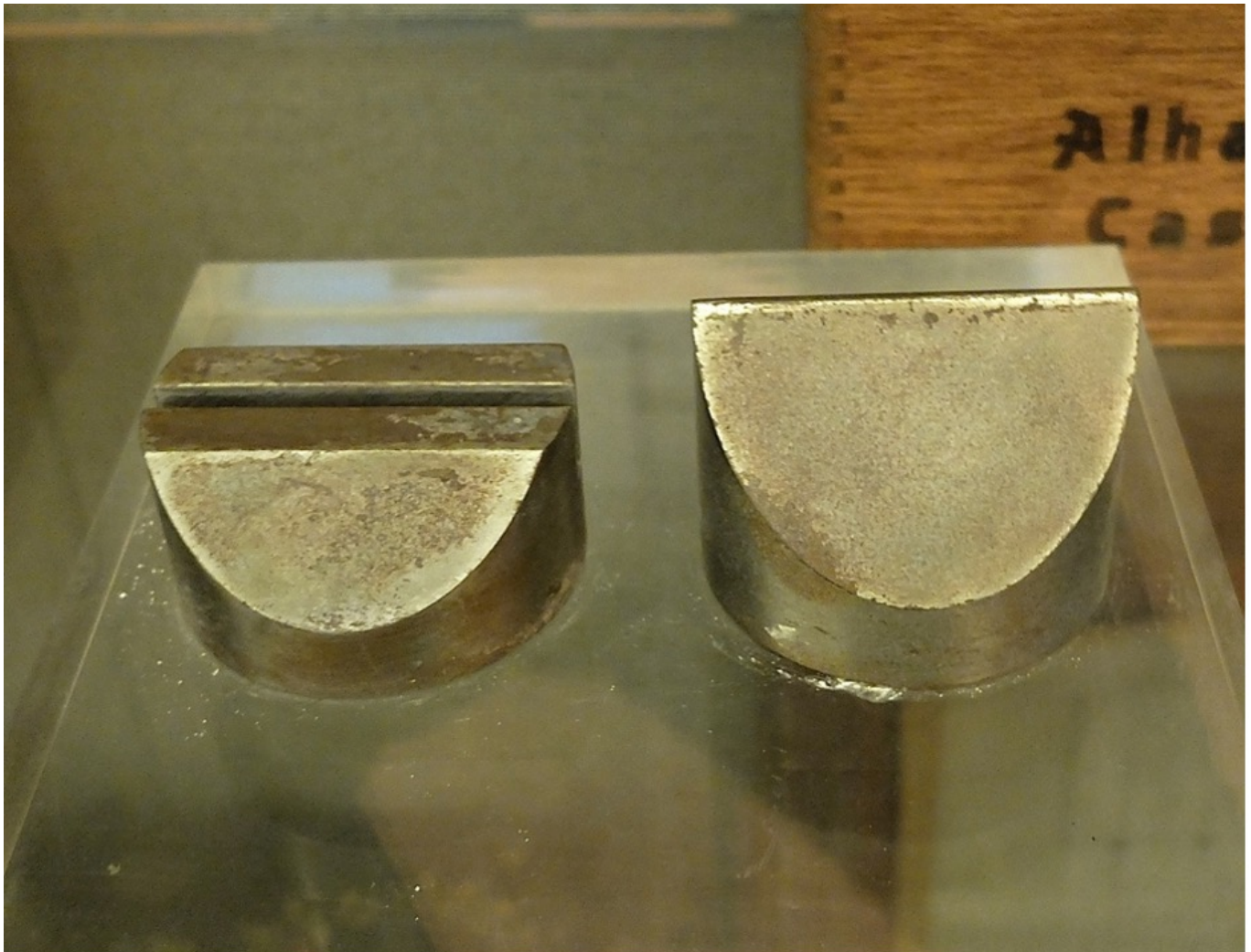
Afbeelding 4. De magneten die gebruikt zijn in het originele Stern-Gerlach-experiment. De magneten bevinden zich in de Carnegie-Mellon universiteit. Foto gemaakt door prof. Tim St. Pierre .
