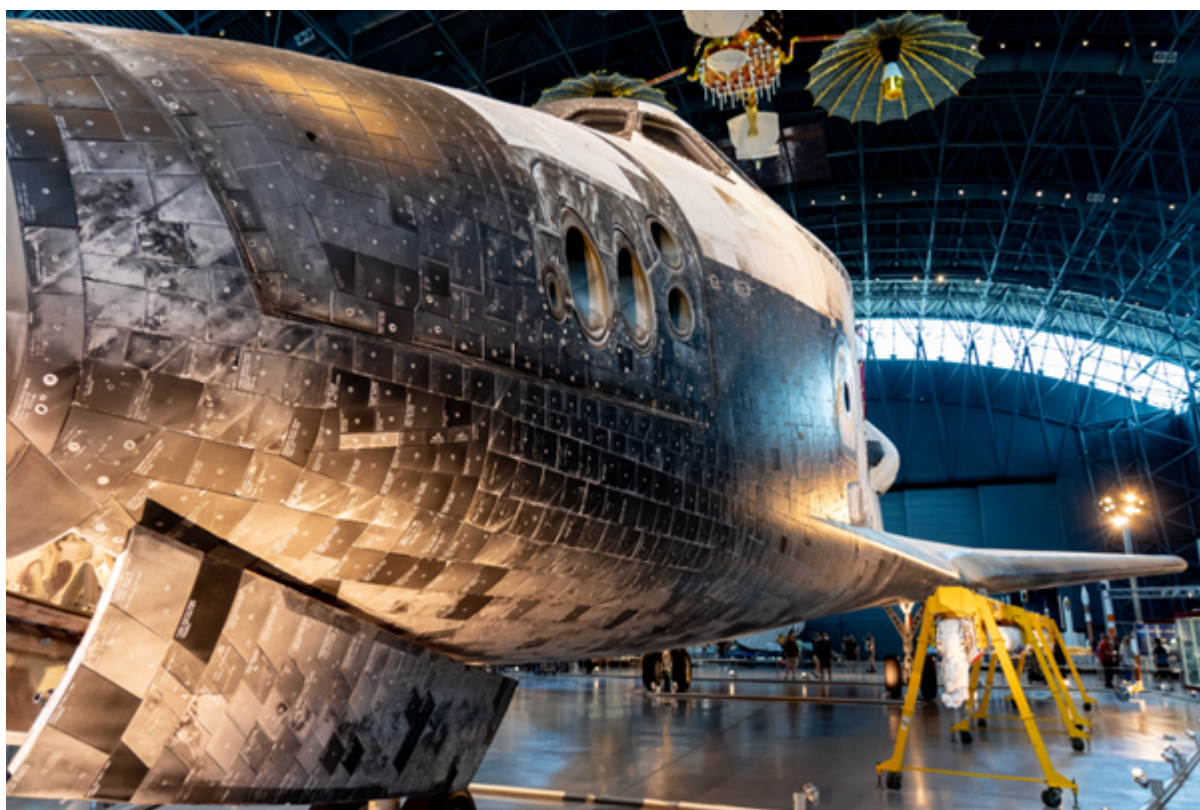
Afbeelding 6. Hitteschildtegels op Space Shuttle Discovery. Foto: Jonathan Cutrer, via Wikimedia Commons .
