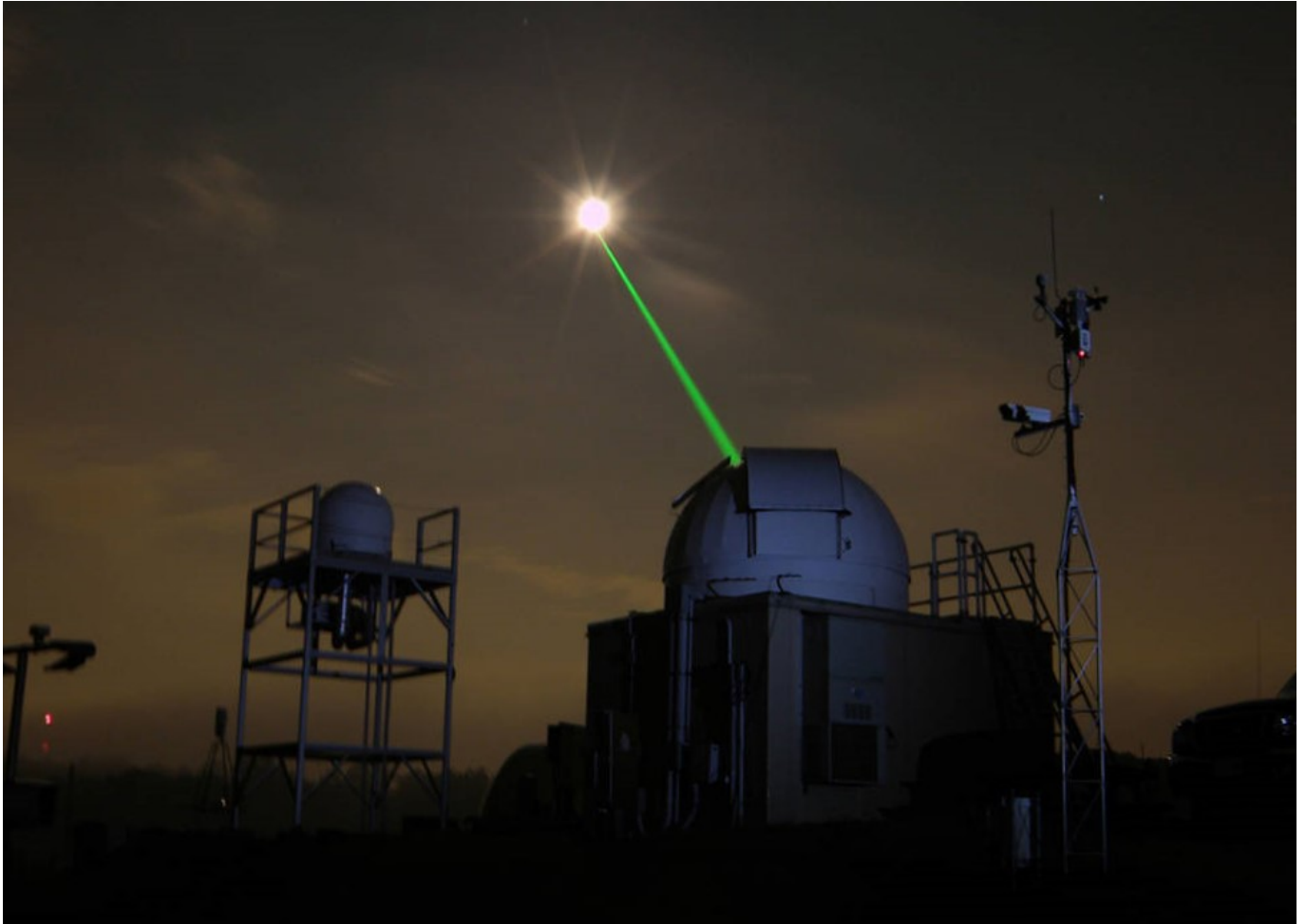
Afbeelding 2. Zo meten we de afstand naar de maan. De Laser Ranging Facility van het Goddard Space Flight Center richt een laser naar de maan. Foto: NASA/Tom Zagwodzki
