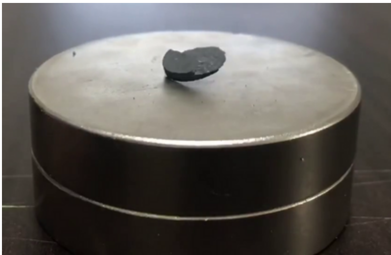
Afbeelding 1. Een samengedrukt stukje LK-99 zweeft boven een magneet. Foto: Stilstaand beeld uit video van de Universiteit van Korea.
