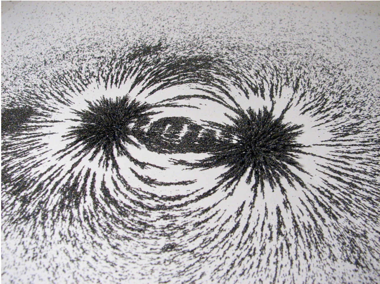
Afbeelding 2. Een magnetisch veld. Magnetische veldlijnen kun je niet rechtstreeks zien, maar door hun effect op ijzervijlsel kun je ze wel zichtbaar maken. Foto: Windell Oskay (CC-BY 2.0).
