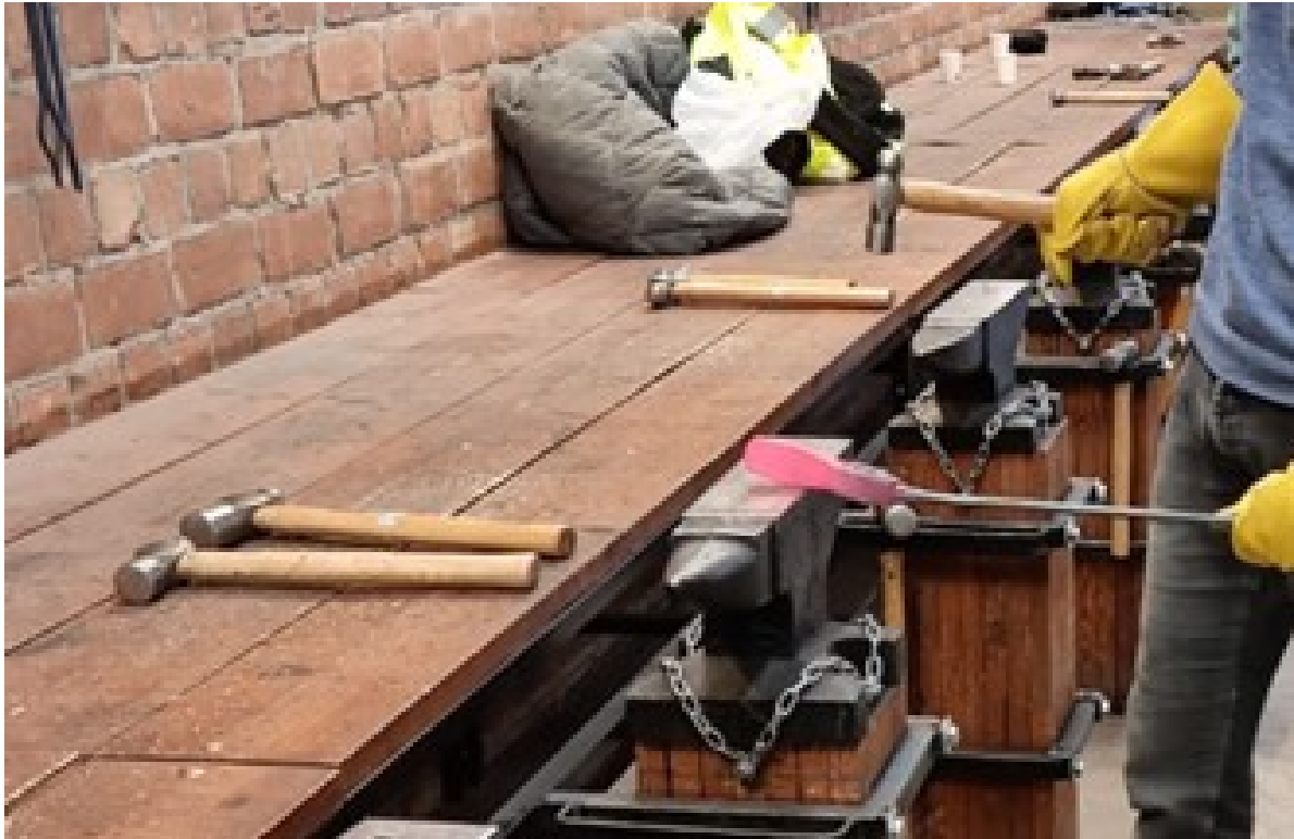
Afbeelding 5. Heet staal straalt zichtbaar licht uit. Een bekend verschijnsel in een smederij. Afbeelding gemaakt door de auteur.
