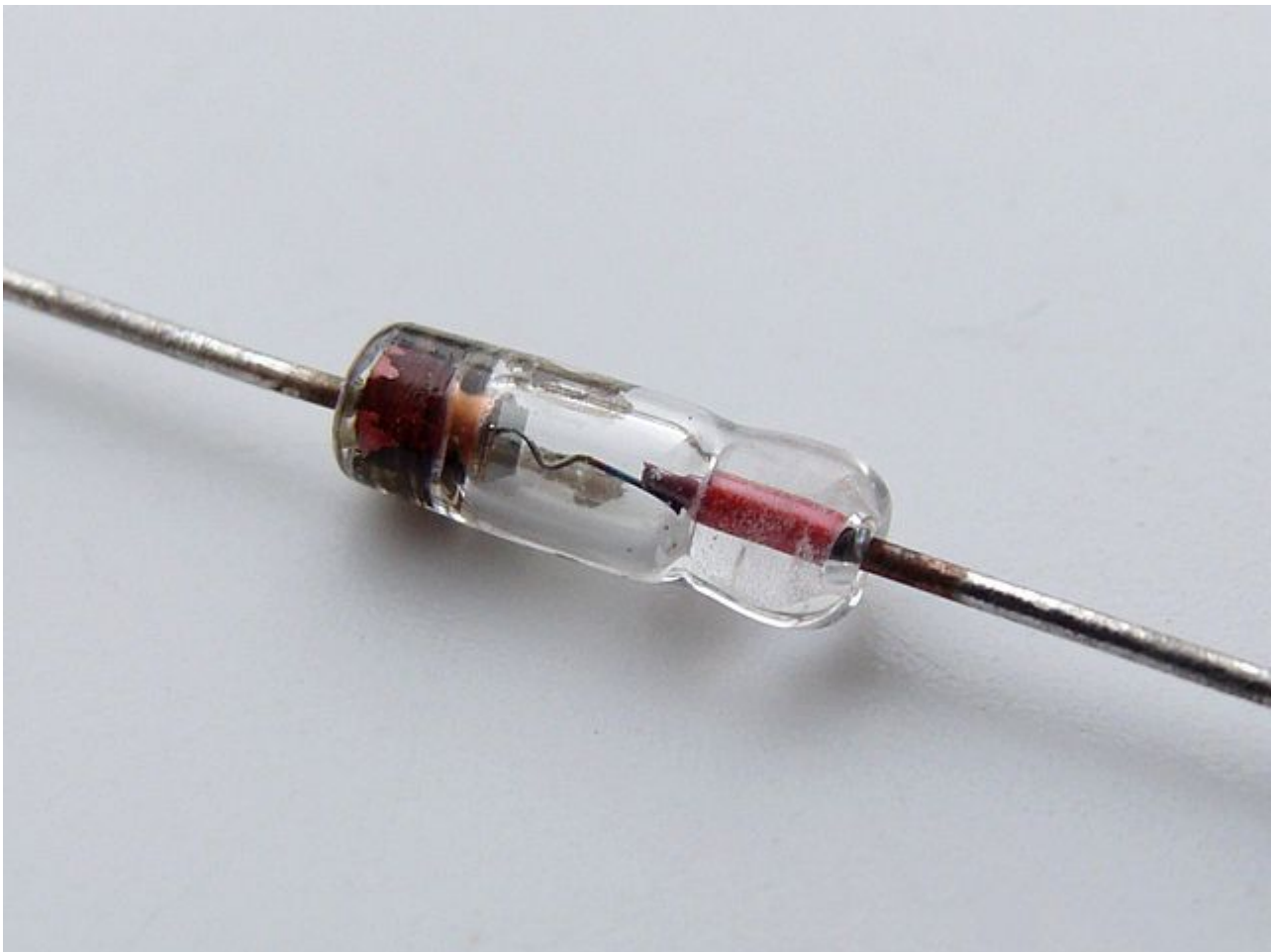
Afbeelding 1. Een germanium-diode. Diodes zijn elektronica componenten die gebruik maken van pn-overgangen. Het grijze blokje linksboven, op het oranje voetje, is de halfgeleider die de pn-overgang bevat. Foto: Wikipedia-
