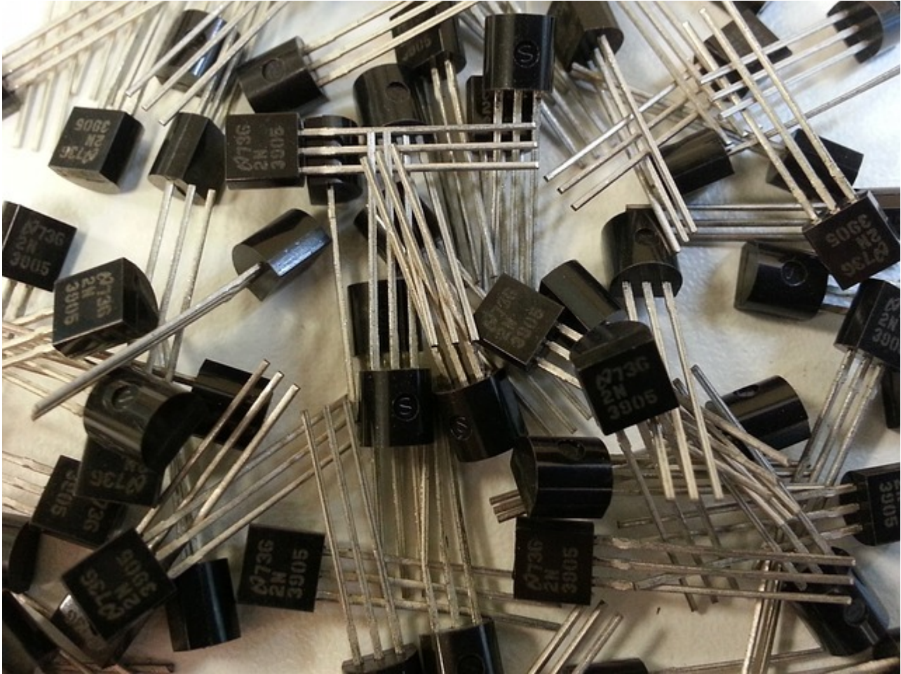
Afbeelding 5. Een verzameling transistoren. Elke transistor heeft drie aansluitpunten: de basis in het midden, en de twee buitenste aansluitpunten waarover de grote totale stroom loopt. Afbeelding: PublicDomainPictures .
