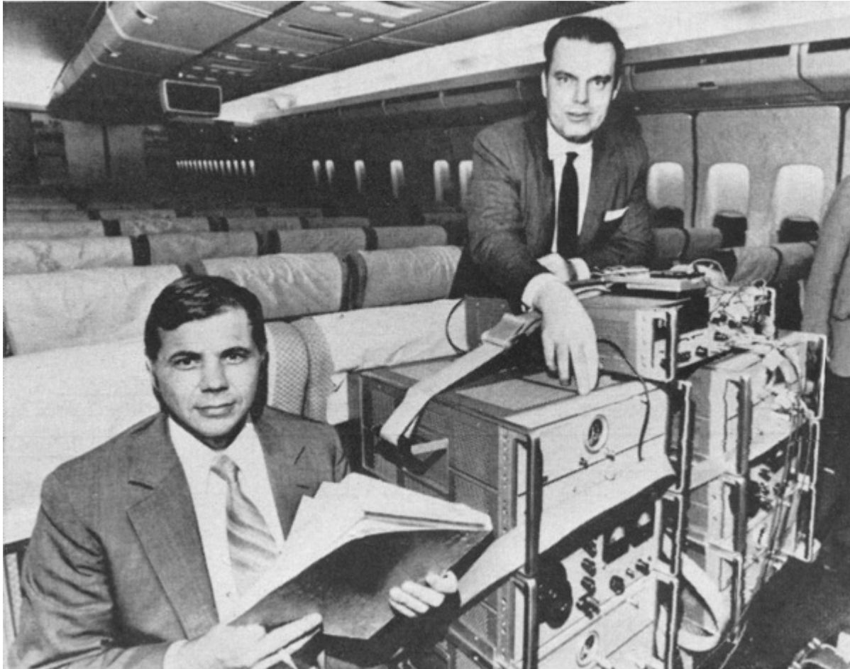
Afbeelding 4. Joseph Hafele en Richard Keating met een van de atoomklokken die in een vliegtuig rond de wereld werd gestuurd. Foto: Time Magazine, 18 oktober 1971.
