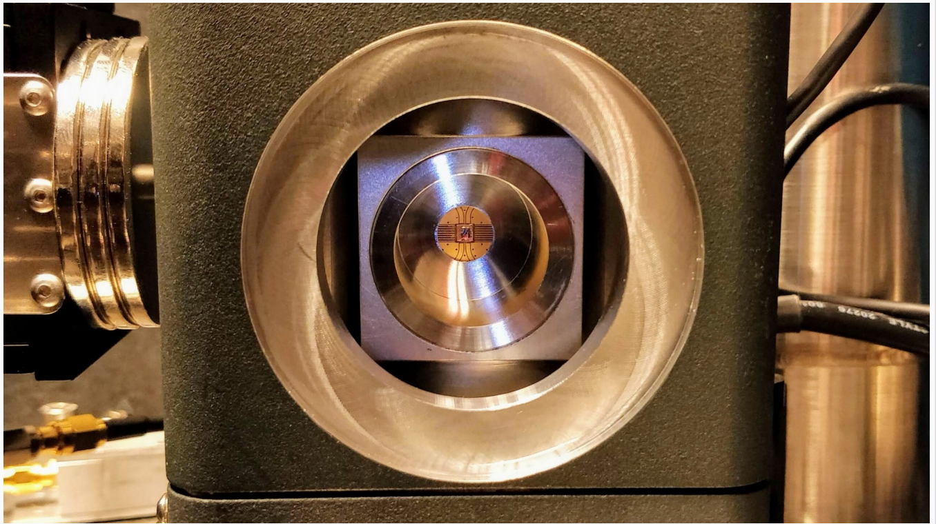
Afbeelding 2. Bob, een diamantchip in het quantumnetwerk Bob is geïnstalleerd in een cryogene confocale microscoop, en wordt bewaard bij een temperatuur van 4 Kelvin. In het midden is de printplaat te zien die wordt gebruikt om elektrische signalen aan de qubits te leveren. Foto: QuTech .
