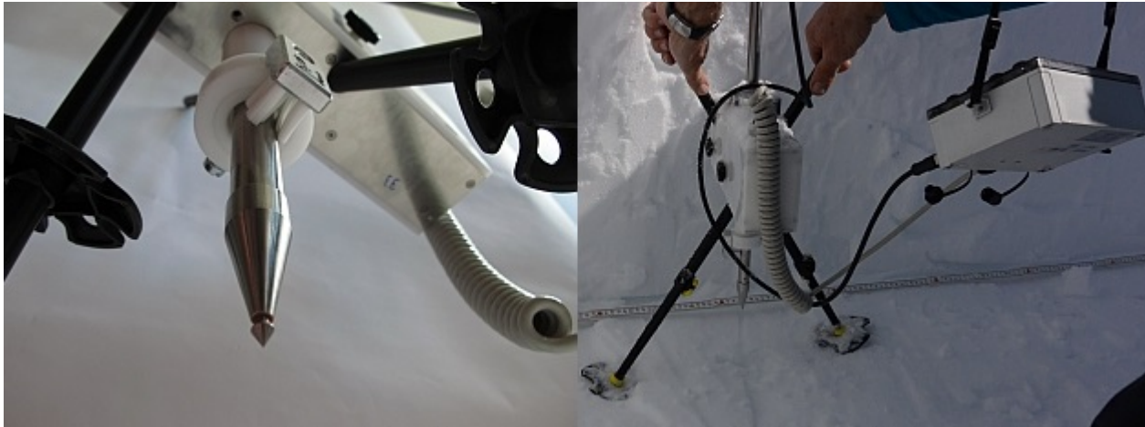
Afbeelding 6. Een SnowMicroPen in gebruik. Bron: SLF.
