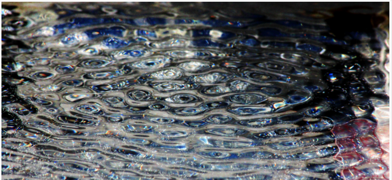
Afbeelding 1: Faradaygolven. Een schaal met water trilt met een frequentie van 82 Hz. Dit zorgt voor het ontstaan van niet-lineaire staande golven die Faradaygolven. Afbeelding: Gardner Nichols en Janelle Montoya .
