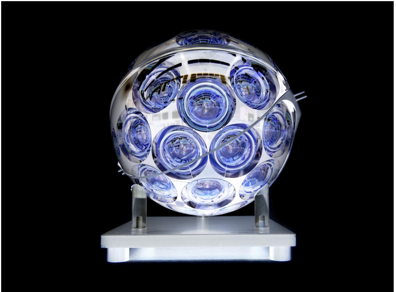
Afbeelding 1. Een “Digital Optical Module,” onderdeel van de neutrinedetector KM3NeT (kort voor “kubieke kilometer-neutrino telescoop”). Deze modules zijn onder andere ontwikkeld op het Nikhef. ©Jos Jansen
