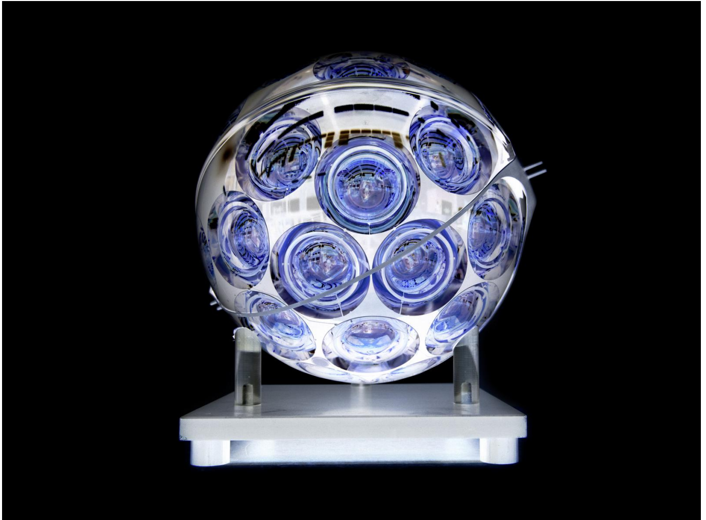
Afbeelding 1. Een “Digital Optical Module,” onderdeel van de neutrinodetector KM3NeT (kort voor “kubieke kilometer-neutrino telescoop”). Deze modules zijn onder andere ontwikkeld op het Nikhef. ©Jos Jansen
